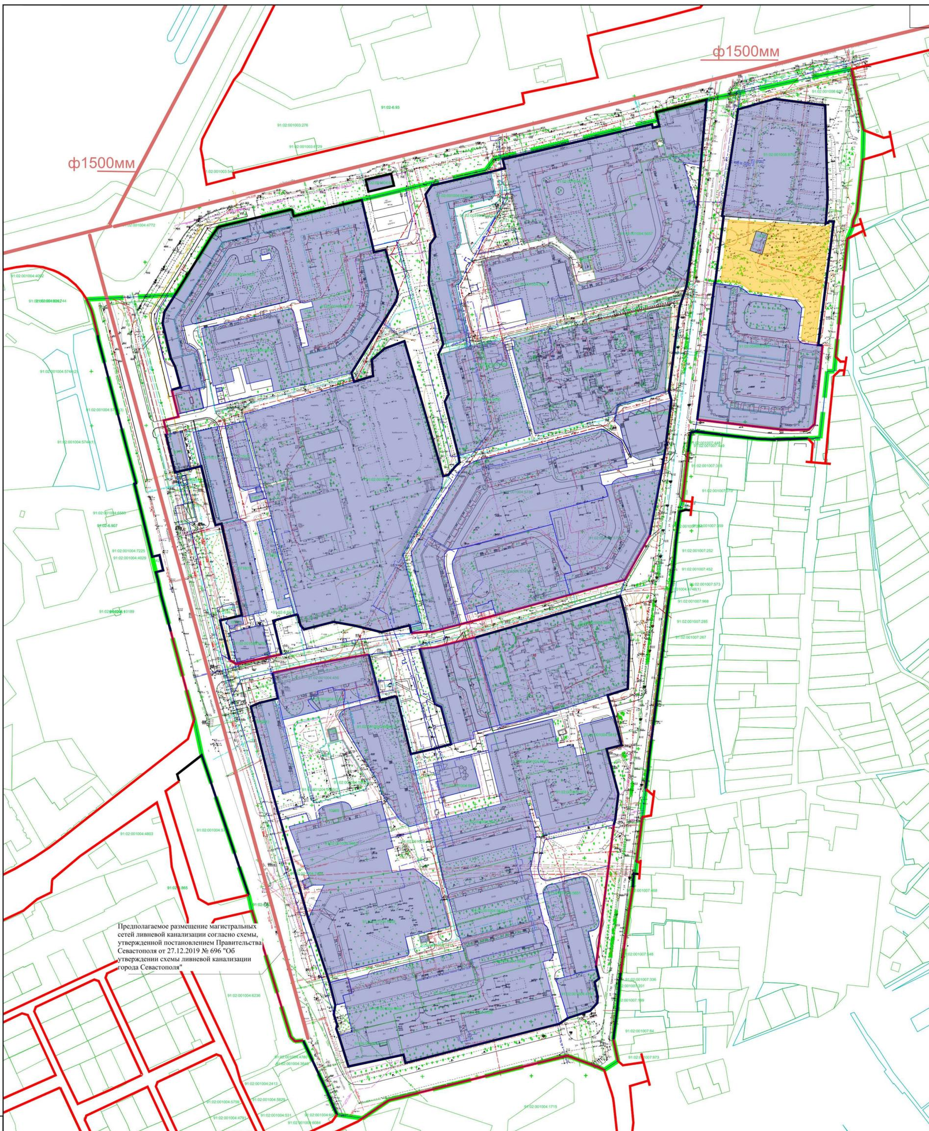
Предлагаемое размещение магистральных сетей ливневой канализации согласно схемы, утвержденной постановлением Правительства Севастополя от 27.12.2019 № 696 "Об утверждении схемы ливневой канализации города Севастополя"
