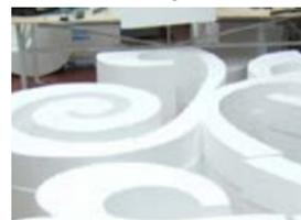
Декор из пенопласта, пенополистирола с цементным покрытием
