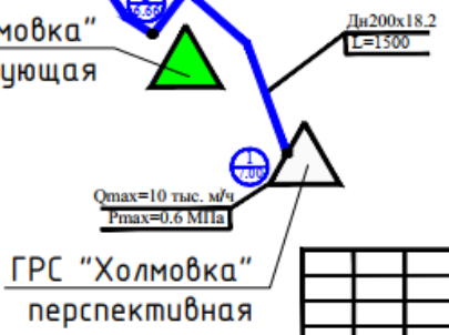
Рис. 13.1.3. Гидравлическая схема газопроводов среднего, высокого давления 2 категории от ГРС «Холмовка»
